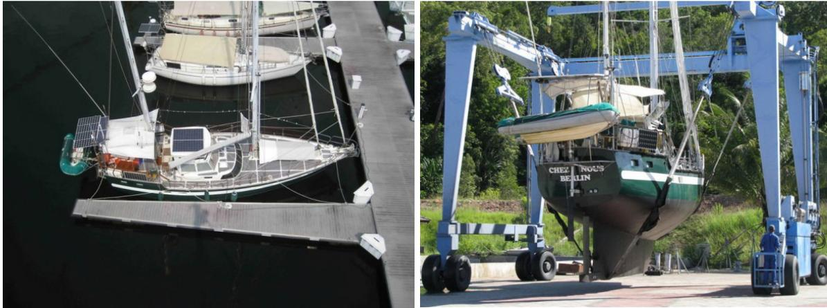
In Dienst gestellt 1981, hat die Scorpion III als gemäßiger Langkieler mit Bugstrahlruder ein Mittelcockpit, das halb überdacht ist mit einem festen Deckhaus, gebaut als Holzkonstruktion mit feststehenden Glasscheiben. Auf dem Dach sind 2 große Solarpaneele angebracht. Weitere Solarflächen befinden sich achtern oberhalb der Davits und an der Reling.
