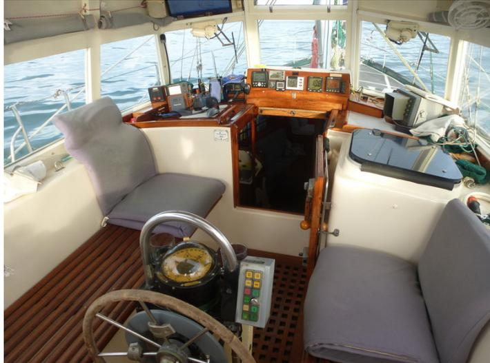
Die Navigationsecke beinhaltet alle Überwachungsinstrumente, Batteriewächter, Sicherungsschalter und einen Teil der Navigationsgeräte wie GPS, Hand GPS, Computer für elektronische Seekarten, VHF, HF Icom IC M 710 mit Pactor Modem für Sailmail, Navtex receiver Lokata mit Drucker, Wetter Fax Empfänger von Koden mit Drucker, Radardector, Antennen Box AV 205, AIS, Immersat C and mehr...
