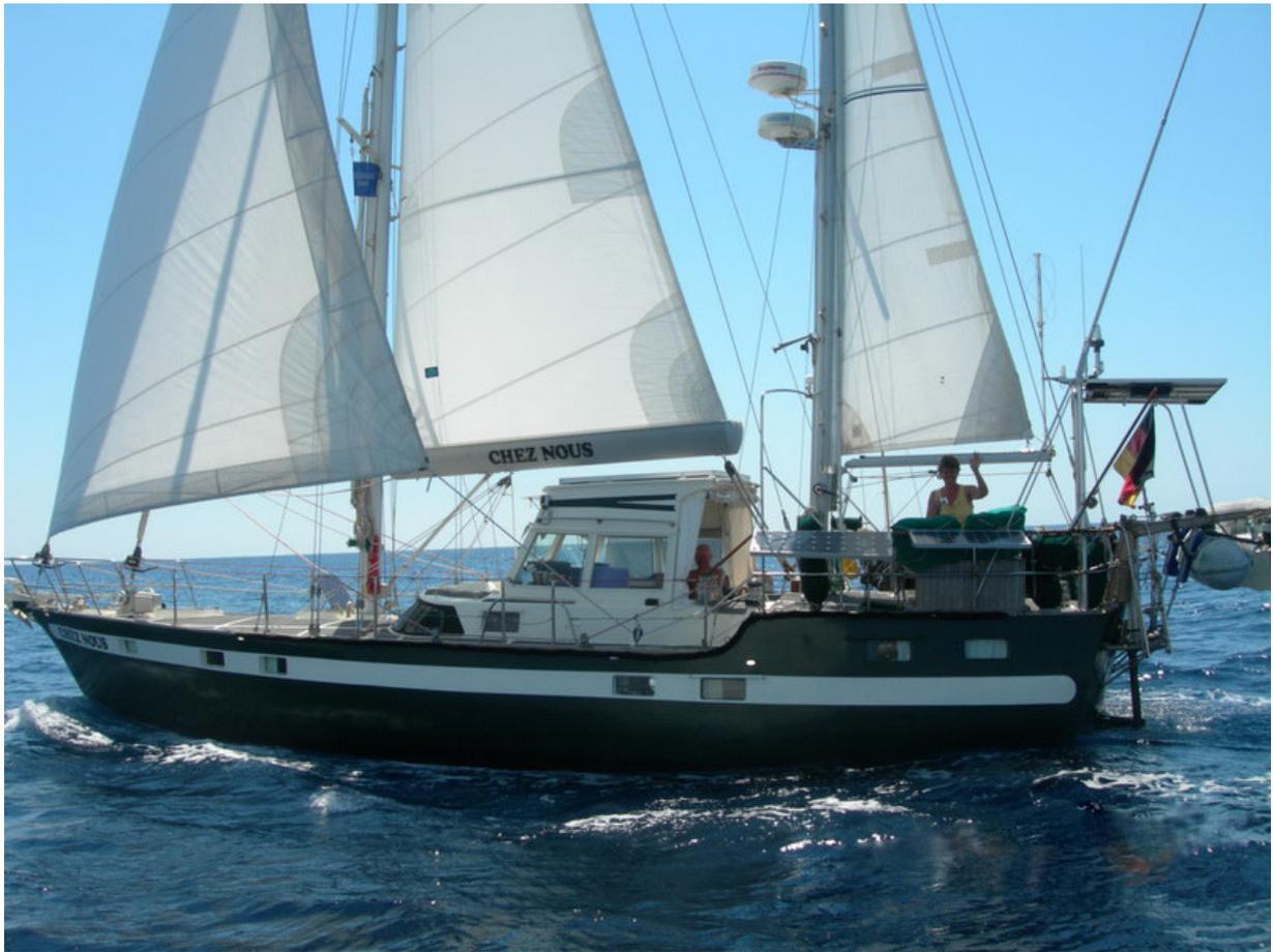
Das Rigg hat Edelstahlwanten mit Norseman Terminals und eine Ketchtakelung. Der Großmast aus Alu (18m) mit stehendem und laufendem Gut wurde 2001 erneuert. Das Großsegel ist durchgelattet und wird in den Baum gerollt: System Profurl.
