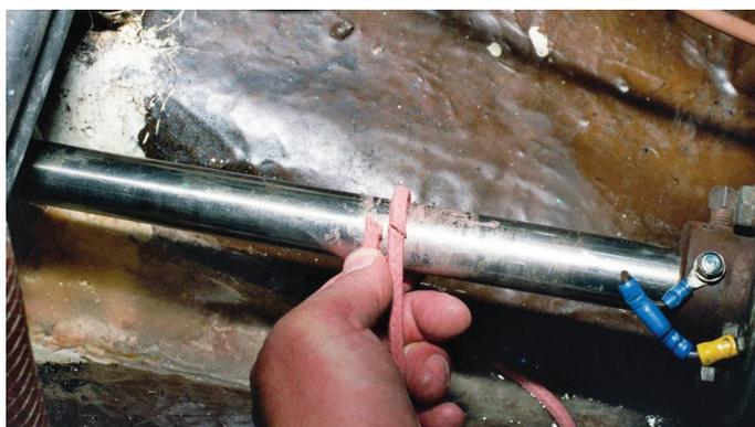
Die Dichtschnur wird lose um die Welle gewickelt und dann beide Enden parallel abgeschnitten, sodass der Winkel gleich ist. Damit die Enden nicht ausfransen, können sie vor dem Schnitt mit Klebeband umwickelt werden.
