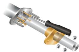
3 jetzt beginnt der schwierige Teil: Die einzelnen Packungsringe werden aus der Buchse entfernt. Die von uns angewendete Methode bestand darin, lange Holz- oder Spaxschrauben in das Packungsmaterial einzudrehen und die Packungen mit den Schrauben aus
