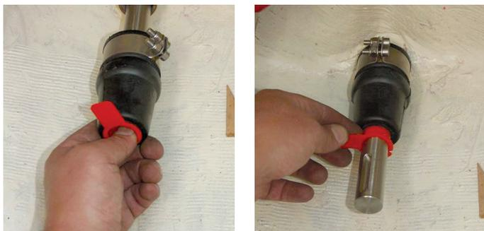
Die Montage einer Lippendichtung ist denkbar einfach, sobald der Wellenflansch gelöst ist. Wichtig ist, dass die Dichtlippen nicht mit Graten auf der Welle in Kontakt kommen oder sogar darauf laufen.
