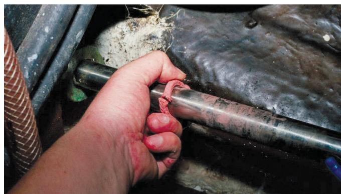
Diese Dichtschnur wurde zu kurz abgeschnitten: Die Enden werden in der Buchse nicht aneinander liegen - so entsteht ein Spalt, der die Dichtwirkung erheblich beeinträchtigt.
