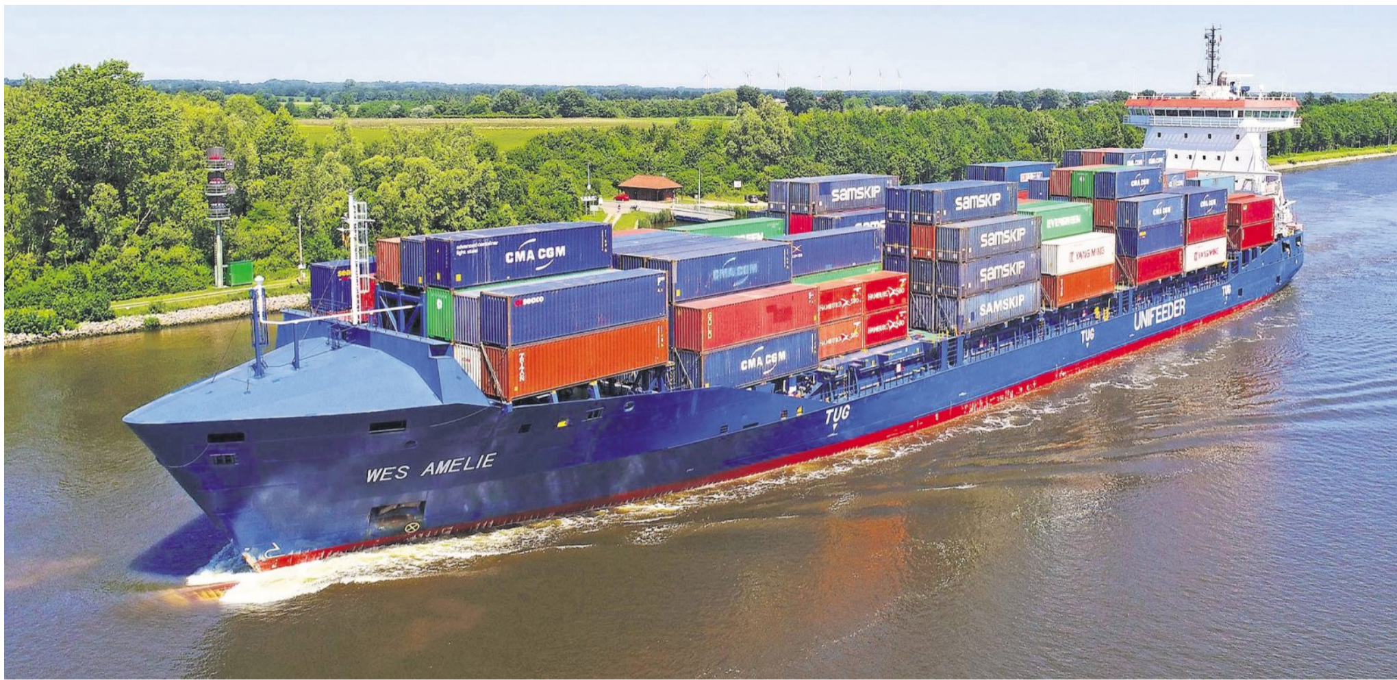
Das Containerschiff „Wes Amelie“ der Reederei Wessels aus Haren an der Ems wird angetrieben von einem Motor, der mit Flüssiggas LNG betrieben wird. Das ist derzeit die umweltfreundlichste Alternative zu herkömmlichen Treibstoffen. Foto: Wessels Reederei GmbH & Co. KG
