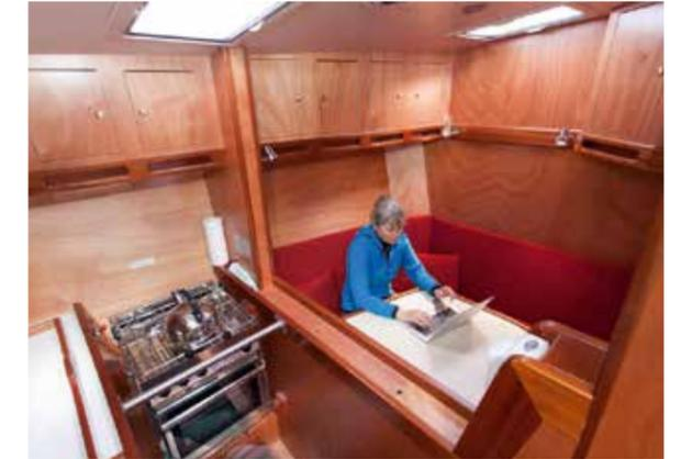
**7.** Achterschiff: Von einem kleinen Vorraum führen Türen in die drei Kammern mit je zwei Kojen. Wie im Vorschiff ist die untere Koje breiter als die obere. An allen Kojen können Leebretter angebracht werden, die sonst unter den Matratzen gestaut sind. Sowohl im kleinen Vorraum als auch in den Kammern selbst sind Schränke und Schwalbennester für die persönliche Ausrüstung eingebaut.
