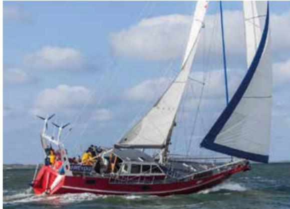
Auch bei der Besegelung stellen wir auf Schwerwetter-Segeln ab. Unsere Tuchstärke beträgt um die 450 g/m<sup>2</sup> und unser Großsegel hat zur einfacheren Handhabung keine Latten. Das Trysegel kann in einer eigenen Schiene am Mast schon frühzeitig untergeschlagen werden.
